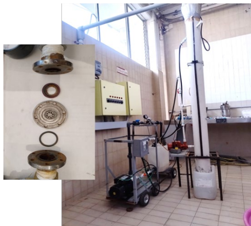
Figura 3. Aspecto general del CH del CeProBi y de la placa perforada usada.
